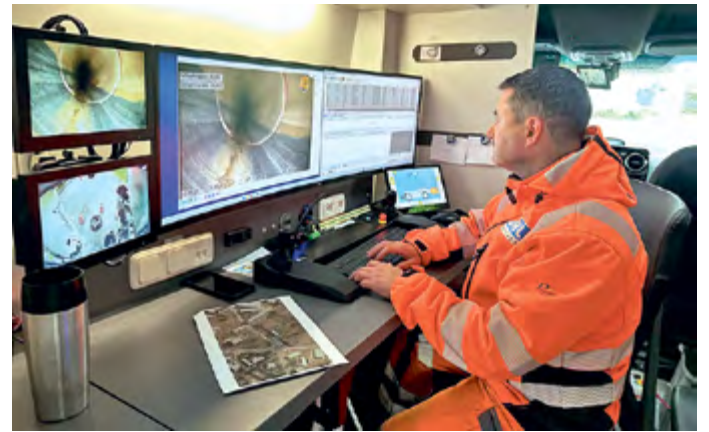
Im Spezialfahrzeug verfolgt Dominic Gertz an seinen Bildschirmen die Fahrt des rollenden Inspektors und dokumentiert Auffälligkeiten der Strecke.
