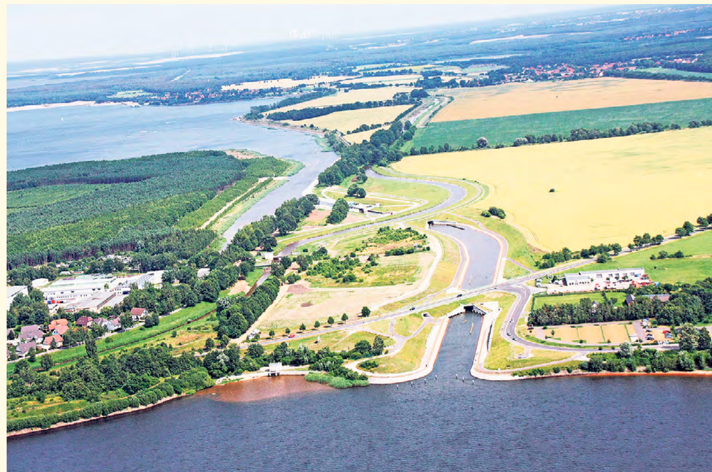
Mit der Flutung der Restlöcher und der Schaffung von Verbindungskanälen in der Bergbaufolgelandschaft entstanden neue Oberflächengewässer, das Grundwasser steigt wieder an. Umfangreiche Maßnahmen zur Gewährleistung einer hohen Gewässergüte gehen seit Jahren damit einher.
