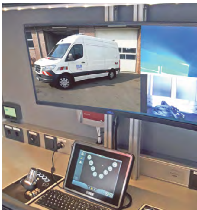
Der Regie-Raum fürs Kanal-TV – von hier aus werden die unterirdischen Bilder ans Licht geholt. Foto: WAL-Betrieb
